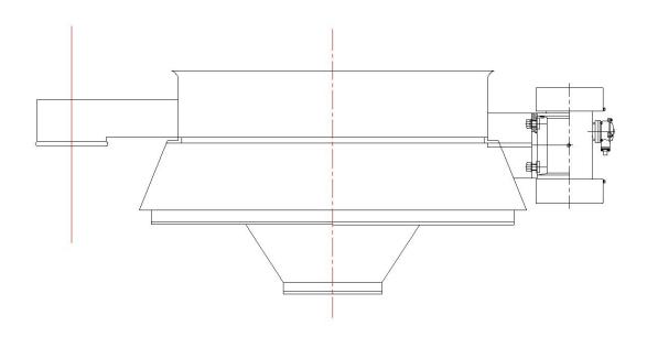
直排筛可以根据处理量大小而选择采用双振动电机或者单振动电机,小处理量一般都用单台振动电机,当要求物料处理量比较大时,将安装两台型号相同的卧式振动电机在筛机两侧,通过调整它们的激振力大小来改变物料在筛面上的运动轨迹,进而达到筛分各种物料的目的。
